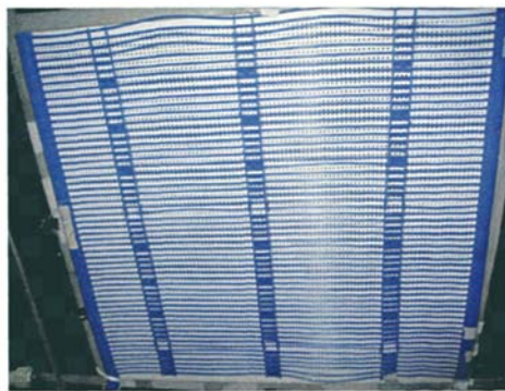
图 3.3 实验测试毛细管辐射冷顶板
